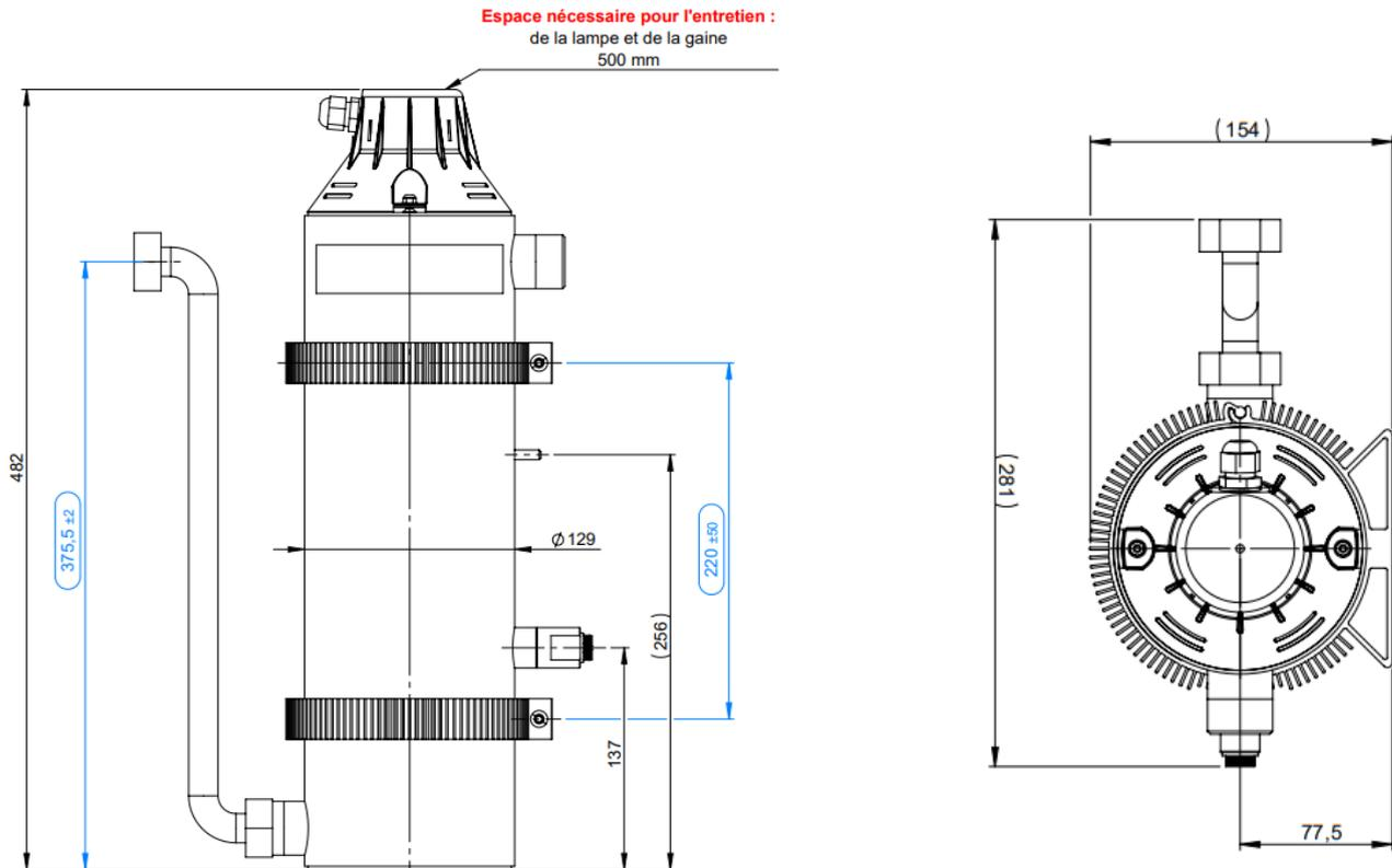
Dans la chambre de traitement, la lampe UV est placée dans une gaine en quartz. Cette réalisation permet d'éviter le refroidissement de la lampe par le passage de l'eau, car son efficacité maximale est à 40°C. La couche d'air entre la gaine et la lampe suffit pour maintenir cette température : la gaine de quartz sert de séparation entre la lampe et le liquide comme isolation électrique et thermique.
