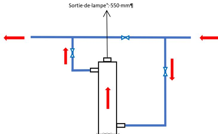
**Il est impératif de toujours positionner l'entrée d'eau sur le piquage le plus bas du réacteur => remplissage par point bas, sortie par point haut, pour évacuer les accumulations d'air**
