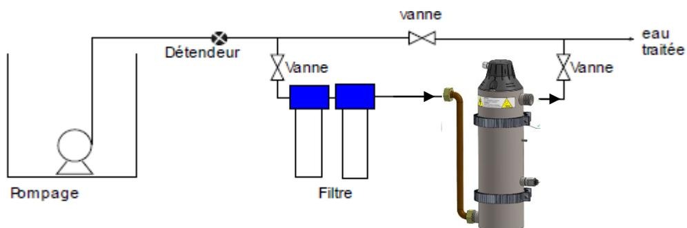
**Il est impératif de toujours positionner l'entrée d'eau sur le piquage le plus bas du réacteur => remplissage par point bas, sortie par point haut, pour évacuer les accumulations d'air**
